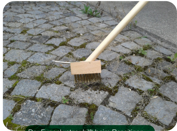
Der Fugenkratzer hilft beim Beseitigen des Unkrauts und ist besser als ein Griff zur Chemie. © Andreas Steinert
